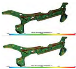
シェル要素への繊維配向テンソルマッピング Courtesy of Renault
